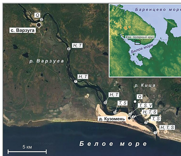
Рис. 1. Нижнее течение р. Варзуги на космоснимке (Google Earth): H, T, S – места установки автоматических приборов, измеряющих уровень, температуру и соленость воды соответственно; T, S, V – полусуточная станция с измерением скорости, температуры и солености воды (рейдовая вертикаль); Q – места измерения расходов воды; 1–8 – пункты экспедиционных наблюдений от устьевого створа; 9 – гидрологический пост р. Варзуга – с. Варзуга.
